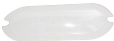
57. skříčko osvětlení zavazadlového a motorového prostoru Tatra 603/1
